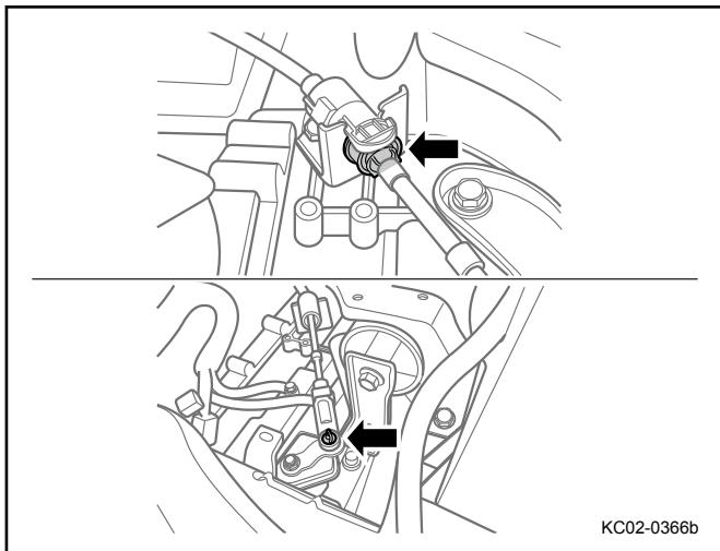
4. 安装换档软轴到自动变速器。
